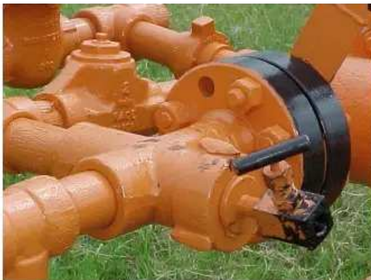
Fig.41 Cruceta portaestrangulador Marca Cameron
