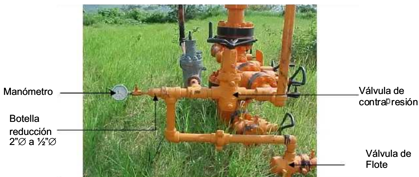
Fig.19 Toma de Presión en TR después del Estrangulador
